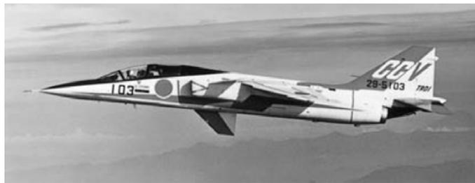
図 1.4-1 飛行試験中の T-2CCV<sup>29)</sup>
